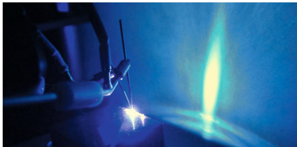
Fernfeld einer InGaN-Rippenwellenleiterlaserdiode im cw-Betrieb. Far-field of a cw InGaN ridge waveguide laser diode.
