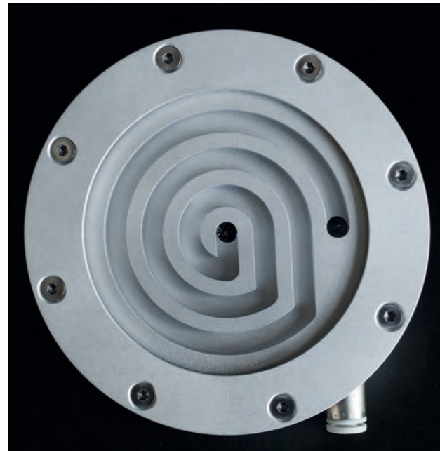
Modul zur Wasserdeseinfektion, links Array von UV-LEDs, rechts Aufsatz für fließendes Wasser. Ein Projekt innerhalb des Applikationslabores. Module for disinfecting water, left array of UV LEDs, right attachment for running water. One of the projects within the application laboratory.
