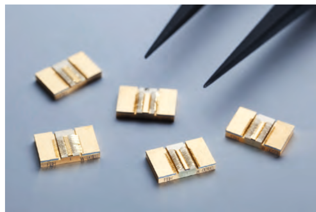
Abb. 1: Klein, aber leistungsstark: Diodenlaser aus dem FBH liefern mehr als 10 W Ausgangsleistung innerhalb eines schmalen Spektralbereichs. Fig. 1: Small, but high powered: FBH diode lasers deliver more than 10 W in a narrow spectral line.
